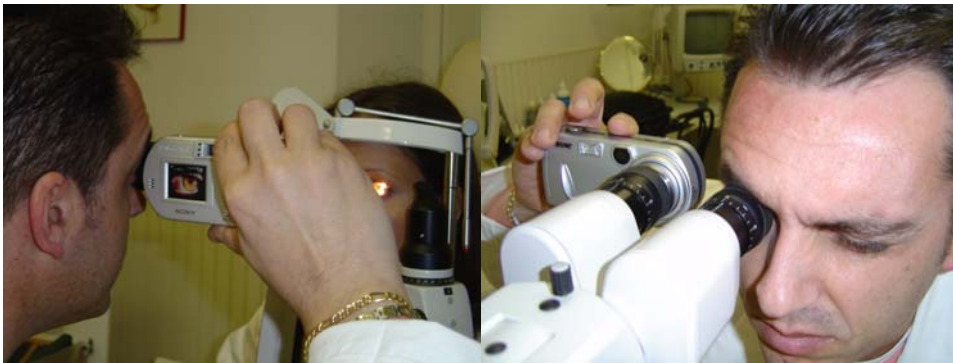
Fig.6 – Controllo della messa a fuoco mediante l'oculare libero.
