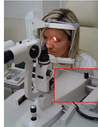
Fig.4 – Posizionamento della lampada a fessura e bloccaggio mediante vite d'arresto (nel riquadro).
