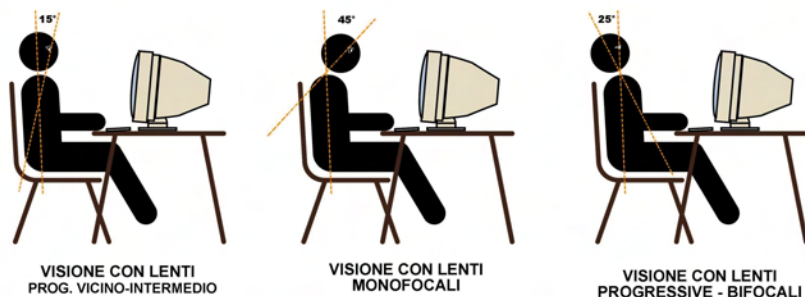
Fig. 2 - Posizioni di un soggetto presbite che usa un videoterminale, in funzione del tipo di compensazione utilizzata.
